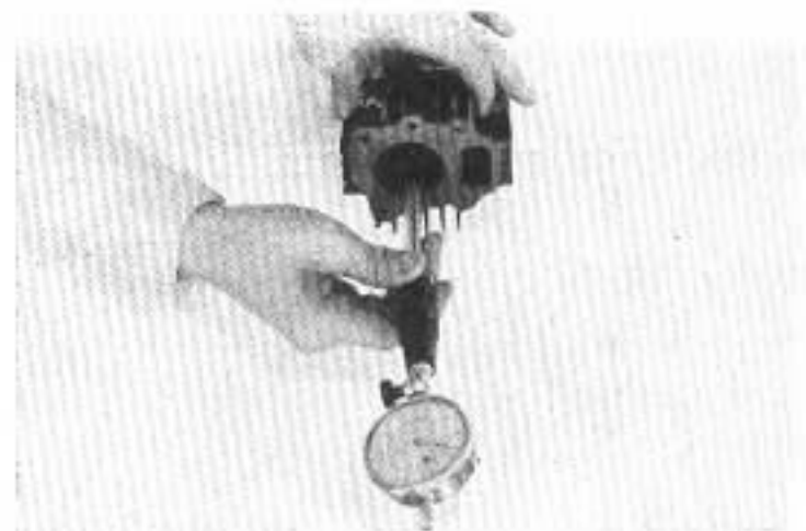
Afb. 65. — HET METEN VAN DE CILINDER BORING.
