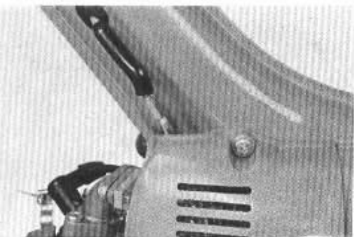
Afb. 49. — AFSTELLEN VAN DE GASKABEL SPELING.
